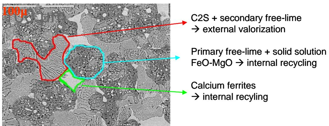
**Figure 8:** Distribution of converter slag minerals and valorisation interest<sup>15</sup>
